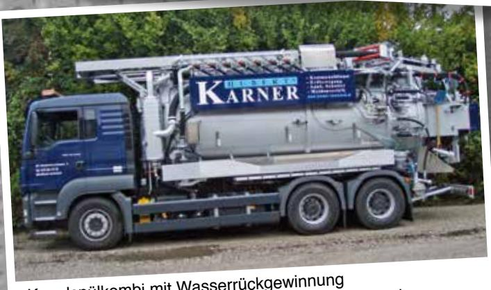
Kanalspülkombi mit Wasserrückgewinnung
